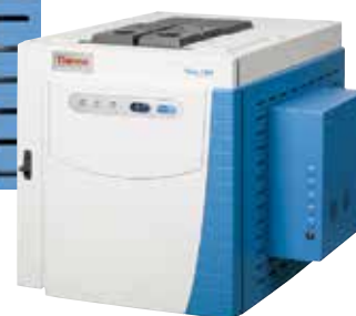
紧凑型辅助阀箱安装于 TRACE 1300E GC 系统的右侧
