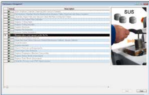
维护管理工具显示了按仪器使用编制的维护任务状态。右侧的图片显示了需进行的操作。
