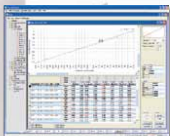
多变量回归校正曲线：真实浓度对强度
