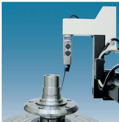
外径的圆度测量示例
