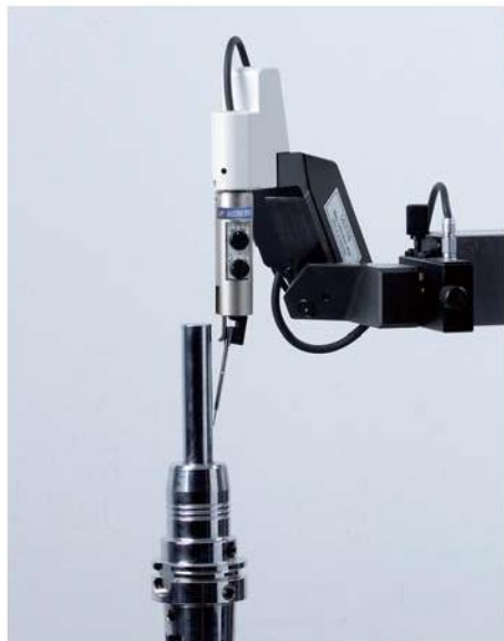
使用偏置型 CNC 传感器保持架 (选配) 进行圆度测量的示例。
