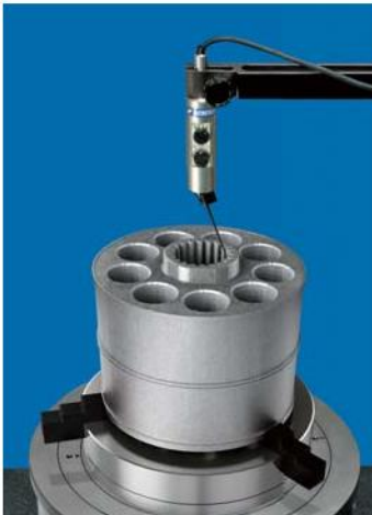
不连续面内径的圆度测量示例
