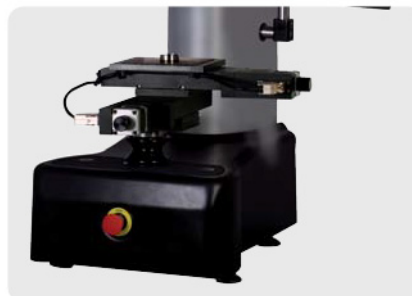
NEMESIS 9003B/HBT 可以配 装手动及自动X-Y工作台。 以上图片显示的是光学250Kgf 自动X-Y工作台。
