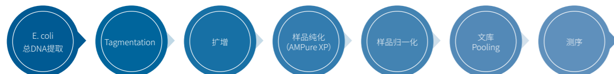
图: Illumina Nextera®XT DNA文库准备流程
