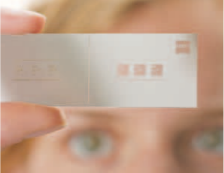
使用 3000 型分辨率检测玻片测试体视显微镜的实际分辨率。
