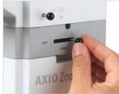
使用控制杆关闭同轴落射照明光源，以启用其它照明方式。
