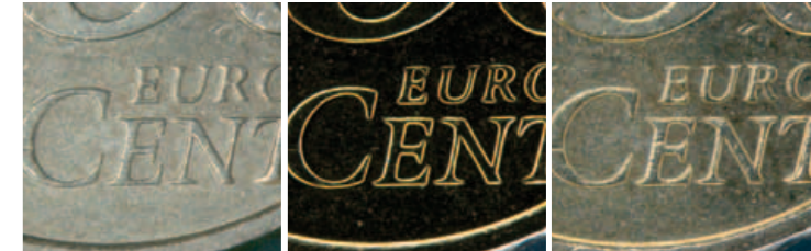
反射光，明场，四分之一环 反射光，暗场，完整环形照明 混合照明，明场与暗场结合形照明
