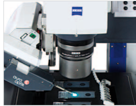
6x stage top holder 载物台取样器和 6x 237 × 157 mm slide tube insert 玻片试管架可用于将精子从细胞混合物中分离出来并移至试管内。
