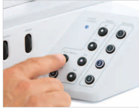
只需点击按钮就能获得透射光照明 - 借助两个滚轮完成照明亮度、对比度和均匀性的调整。
