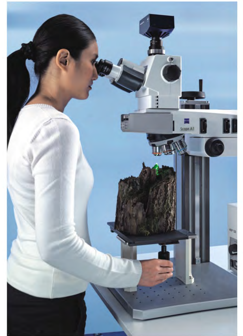
几乎没有大小限制的样品空间：标本可高达 380 毫米，例如树干，可以用 Vario 调焦柱。
