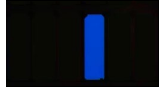
亮 Stuck Pixels 点：蓝色分像素点常亮时在暗背景上显现的常亮点。
