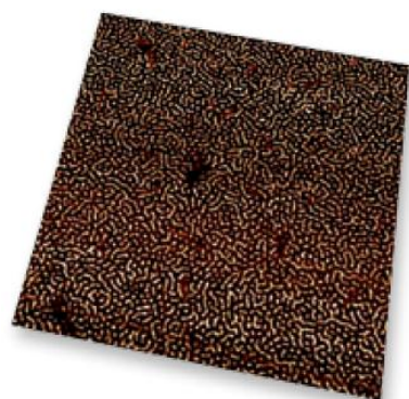
闭环模式下的相位图展现了聚烯(苯乙烯-b-丁二烯-b-苯乙烯)三嵌段共聚物的微相分离。图寸: 2 μm。
