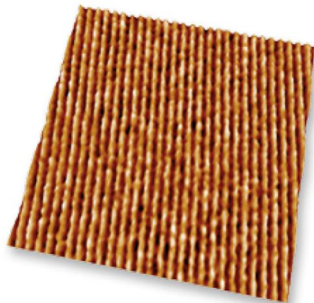
闭环模式下，HOPG上的C 36 H 74 烷烃相位图像。约4.5nm的单个片层结构清晰可见。图像尺寸：130nm。
