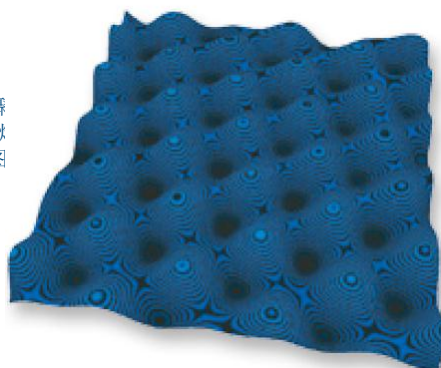
云母原子点阵, 接触模式扫描。图像尺寸: 1.5nm。
