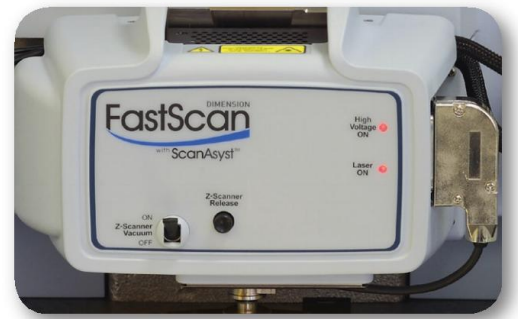
扫描共振频率: X-Y: 2.70 kHz, Z: >50 kHz
