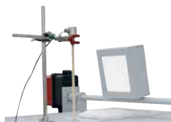
作为附加装备的排气门和带支架的炉料热电偶
