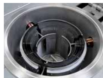
带钨丝加热装置的圆柱形气密罐
