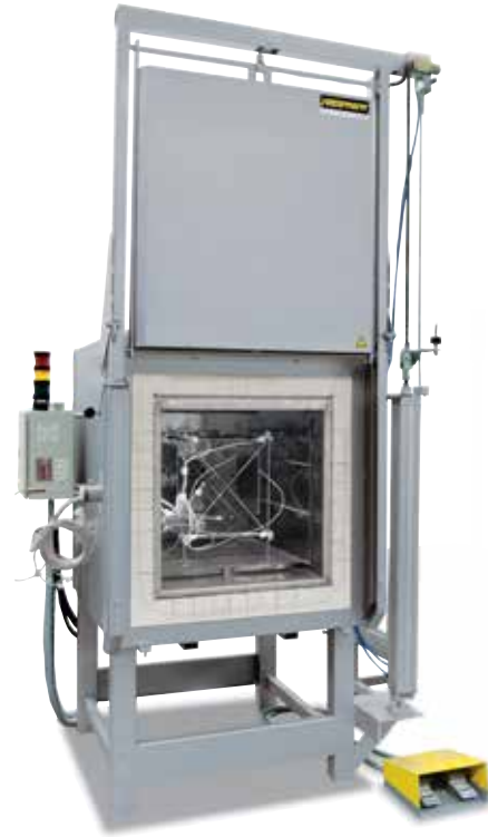
用来测量温度均匀性的测量架
