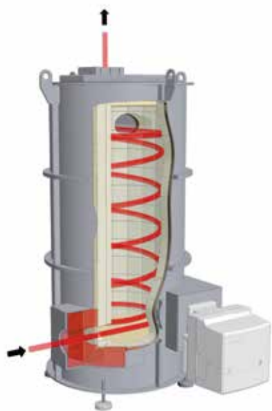
热力式后燃烧器(TNV)示意图
