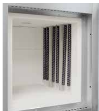
在一台高温炉上的排胶系统配有垂直悬挂式 SiC 棒和可选配的多孔进气管
