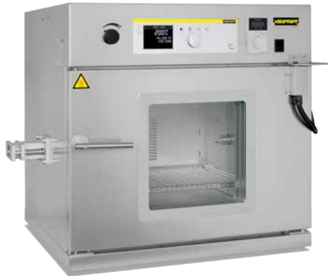
TR 60型烘干箱，带视窗以及转速可调的旋转装置和门锁定装置
