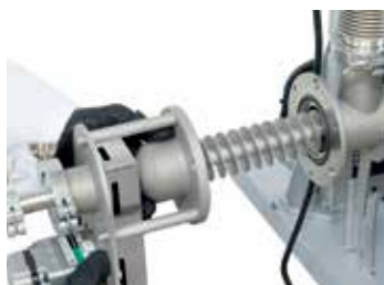
转速可调节式螺旋输送机
