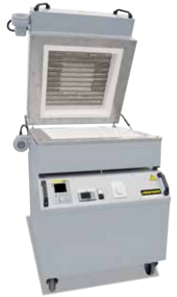
LS 25/13型快速燃烧炉
