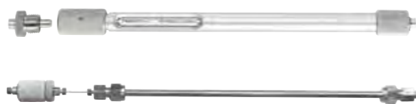
NewGuard柱芯直接连接至一根220 mm MPLC柱芯并与一根250 mm常规色谱柱进行外部连接。
