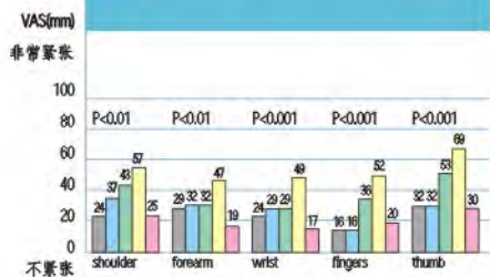
图3. 使用不同移液器时右侧身体所受压力比较，数值越高压力损伤风险越高。
