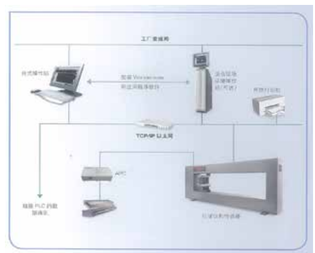
图 2 Beta Plus 在正负极生产环节进行操控和数据传输的示意图
