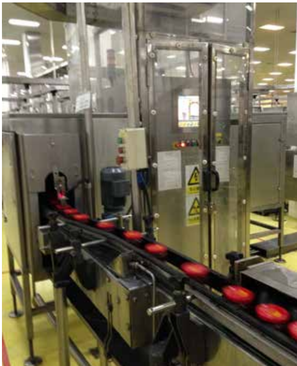
POWERx D230 X 射线异物检测系统在某著名调味品企业生产现场检测实例
