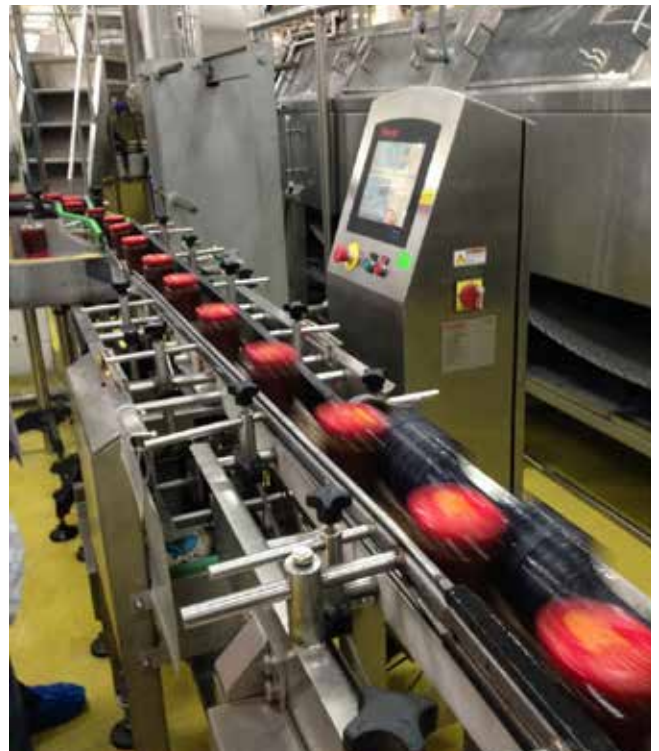
Versa 8120 链式检重秤在某著名调味品企业在线检测实例
