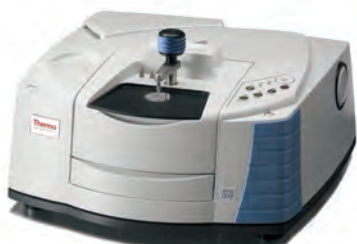
iS10 分析型傅里叶红外光谱仪能为晶型鉴别及制剂研究提供更佳光谱性能和分辨率；每秒 40 次快速扫描性能更是为先导化合物合成反应监控提控了有力有段；可与热重联用，为药物的耐热性以及热分解过程进行分析提供有效数据。
