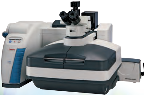
DXRxi 显微拉曼成像光谱仪提供 600 张谱图 / 每秒的快速成像，能大力提高研究型实验室对晶型分析，异物分析，分布分析以及临床药物分析的研究效率，为研究工作在最少的时间提供更多的化学信息
