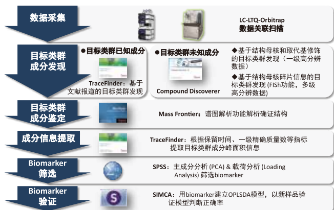
图 1. 基于 LTQ Orbitrap 高分辨质谱与相关软件的中药目标类群成分发现、鉴定和中药组学研究流程
