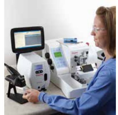
通过软件切片时直接打印玻片
